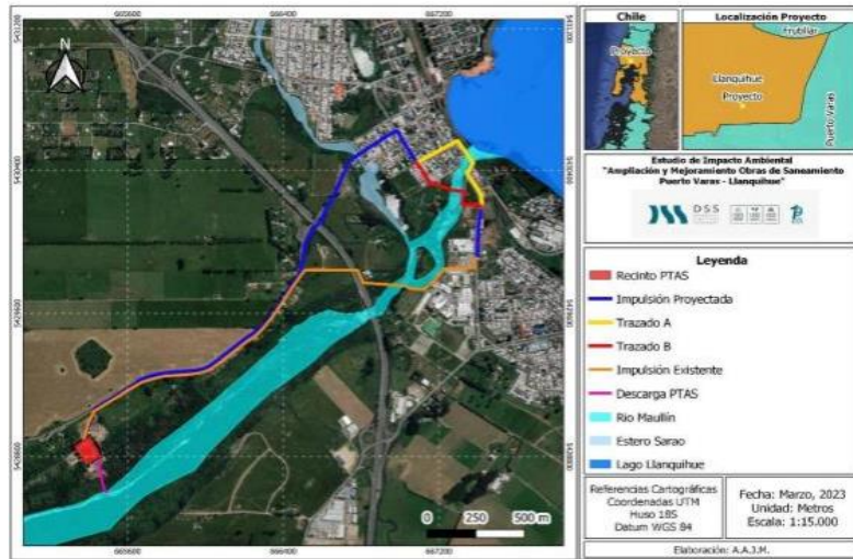
Fig. 8: Zona de descarga y zona por donde pasará la tubería
