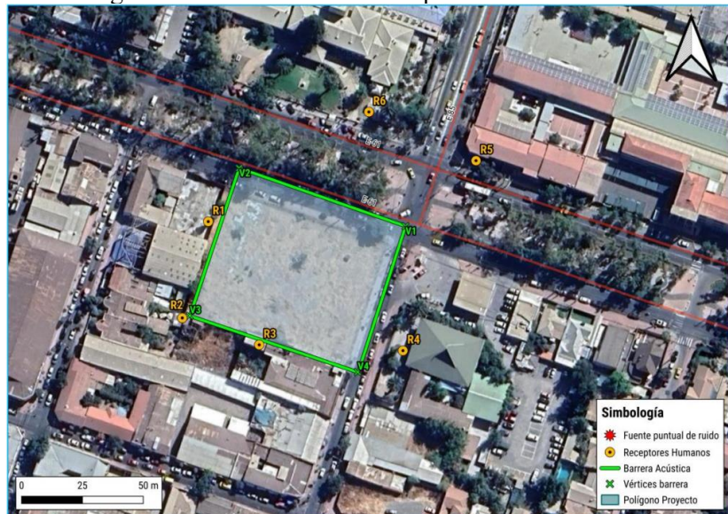
Figura 4.3.1.4: Barrera acústica para fase de construcción.
