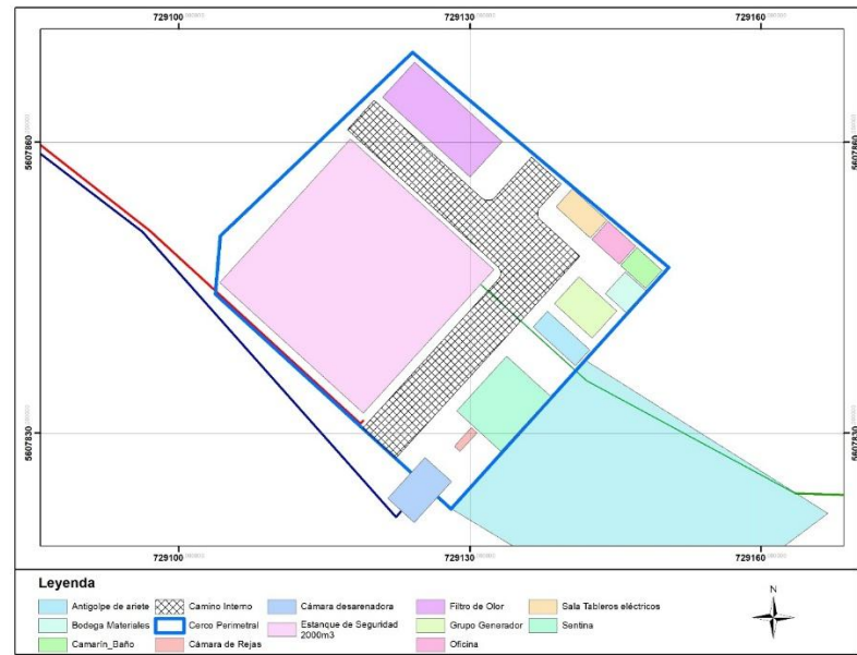
Figura 9 Planta Elevadora Aguas Servidas PEAS Estanque
