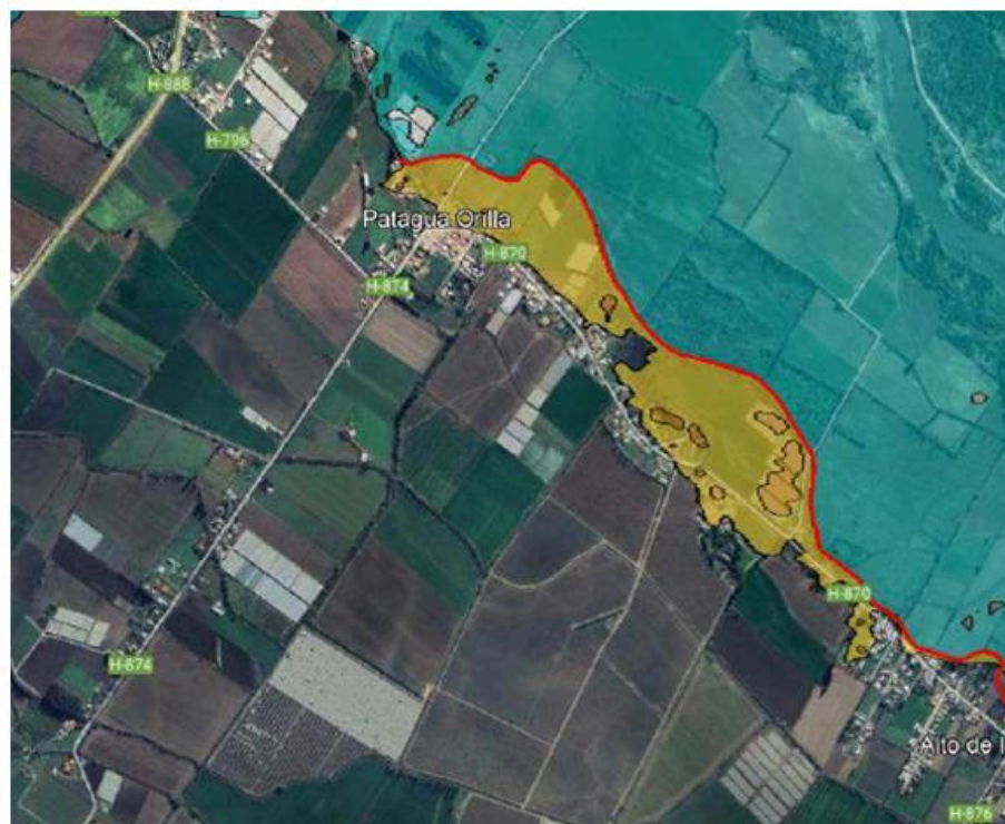
Figura 2. Defensa fluvial propuesta por CFC-2019 entre Lo Madrid y Patagua Orilla y áreas saneadas asociadas.
