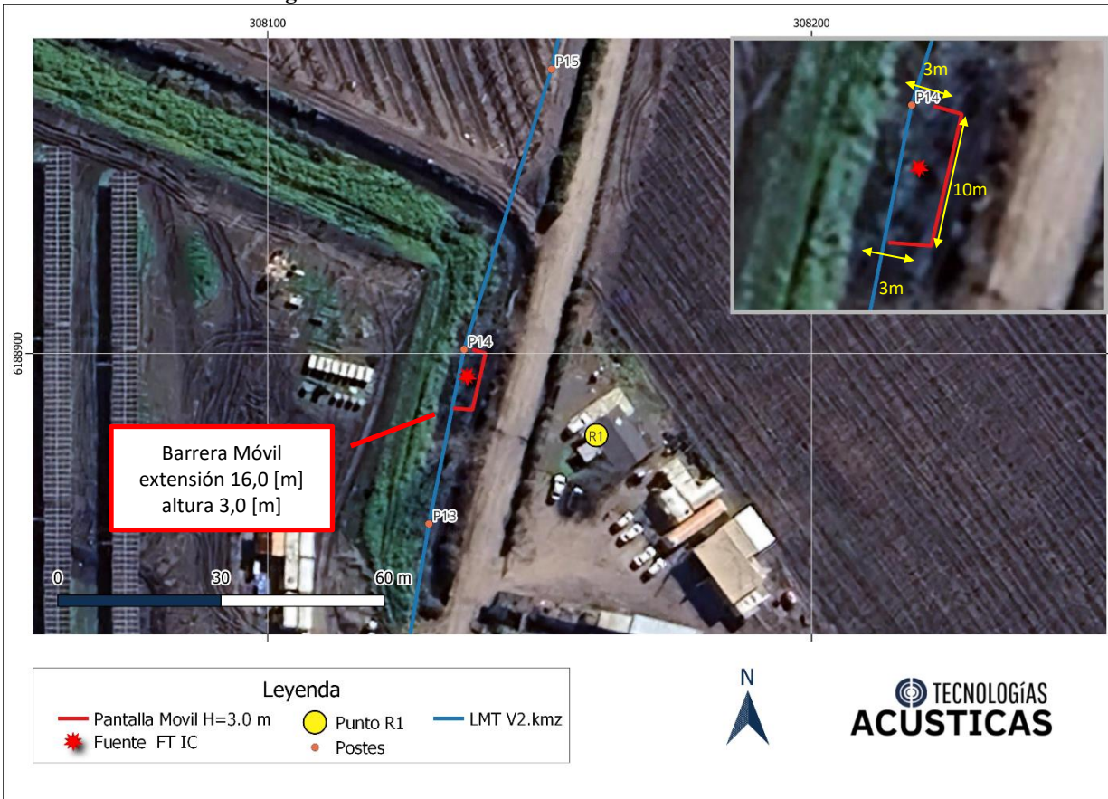
Figura 24 Barrera acústica móvil – FASE de Construcción.
