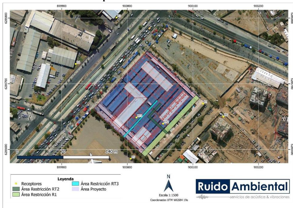
Imagen 12.98: Áreas de Restricción para el uso de Camiones Escenario 5 – Fase de Construcción
