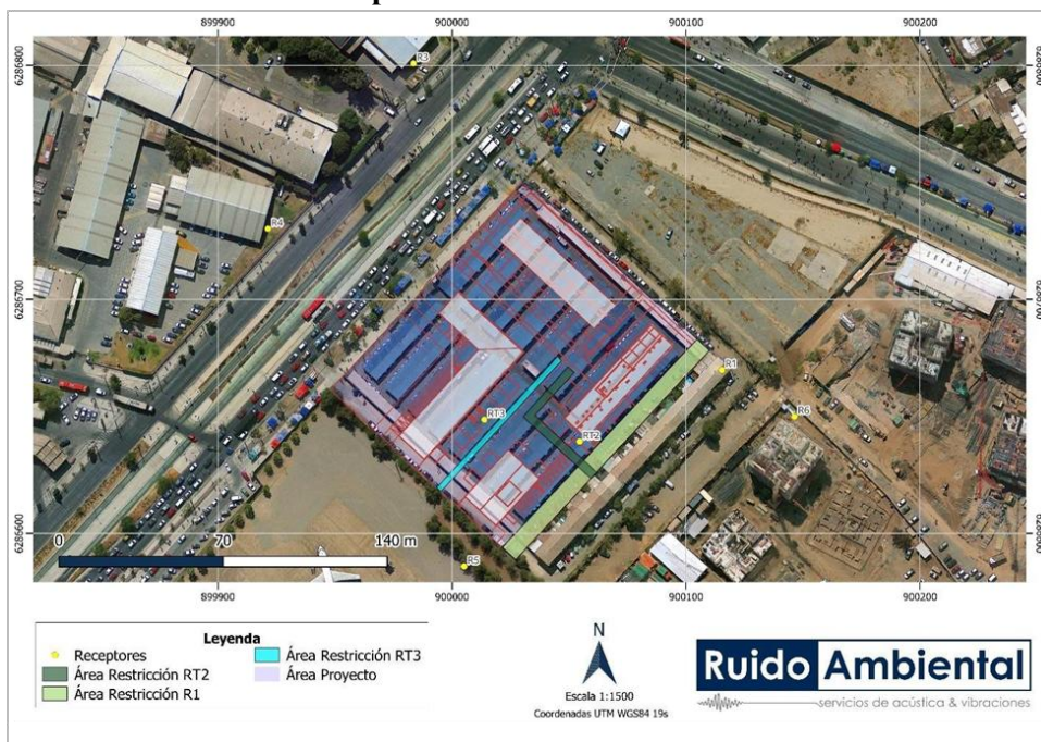
Imagen 12.116: Áreas de Restricción para el uso de Camiones Escenario 5 – Fase de Construcción
