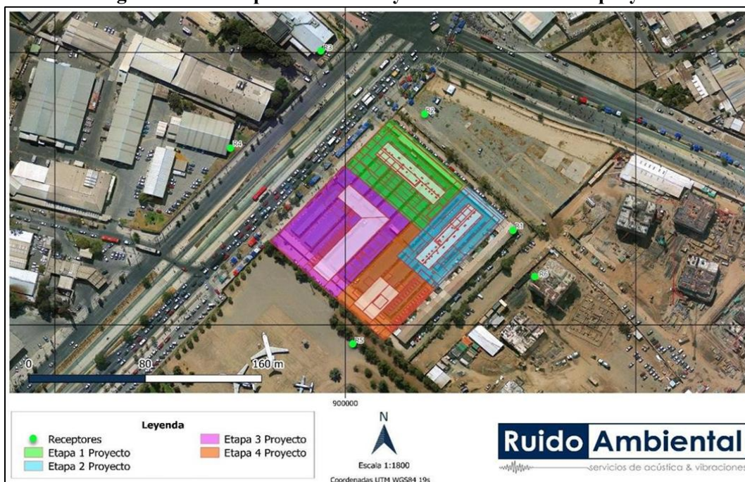
Imagen 12.46: Receptores de ruido y vibración críticos del proyecto
