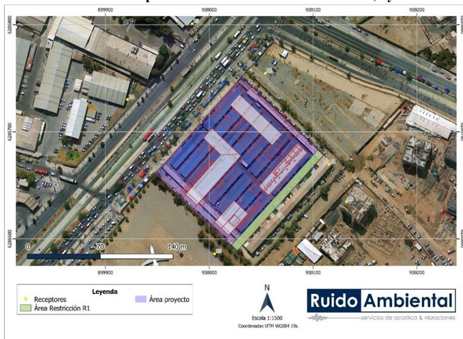
Imagen 12.96: Áreas de Restricción para el uso de Camiones Escenario 1,2 y 3 - Fase de Construcción
