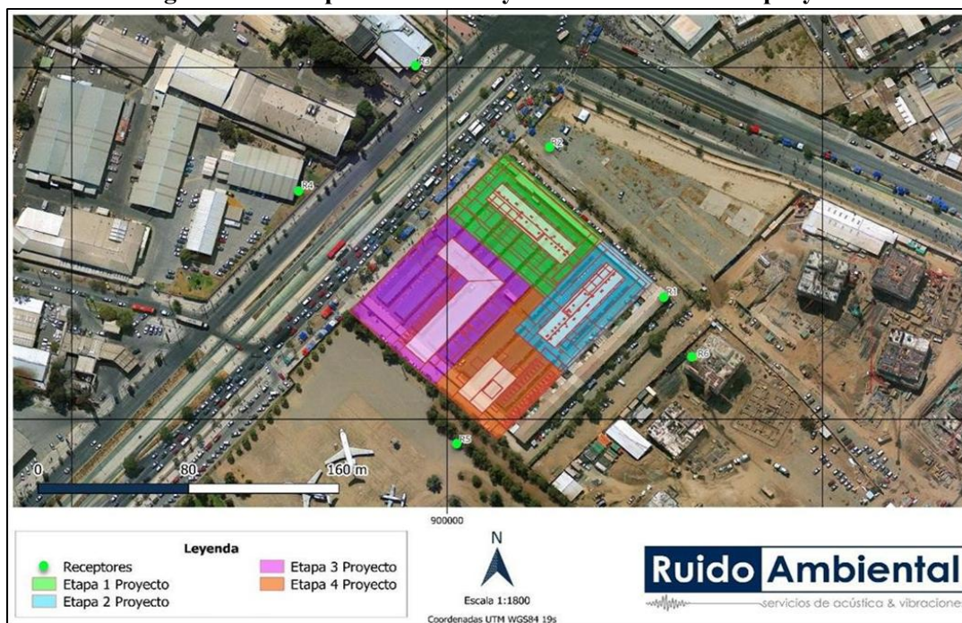
Imagen 12.2: Receptores de ruido y vibración críticos del proyecto
