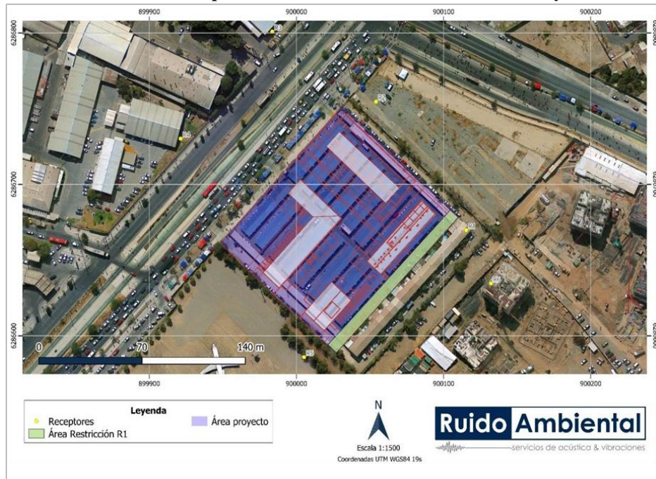
Imagen 12.115: Áreas de Restricción para el uso de Camiones Escenario 1,2 y 3 - Fase de Construcción
