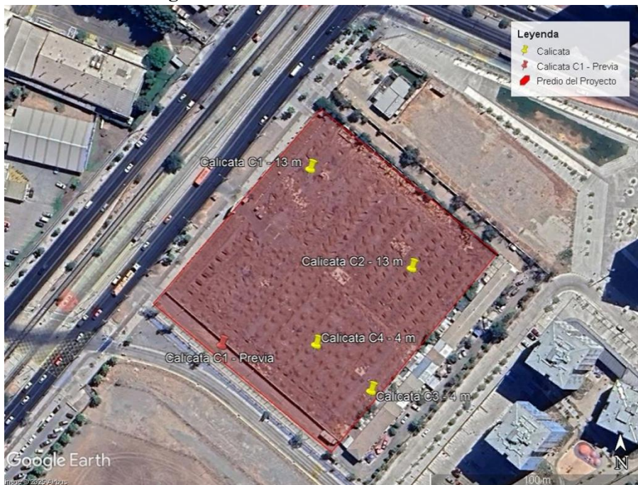
Imagen 12.122: Ubicaciones de las calicatas
