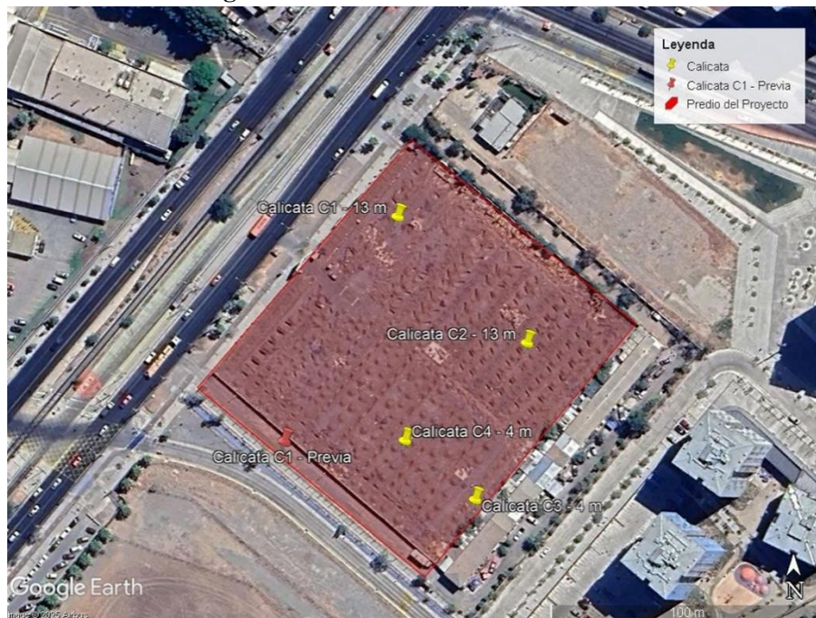
Imagen 12.23: Ubicaciones de las calicatas
