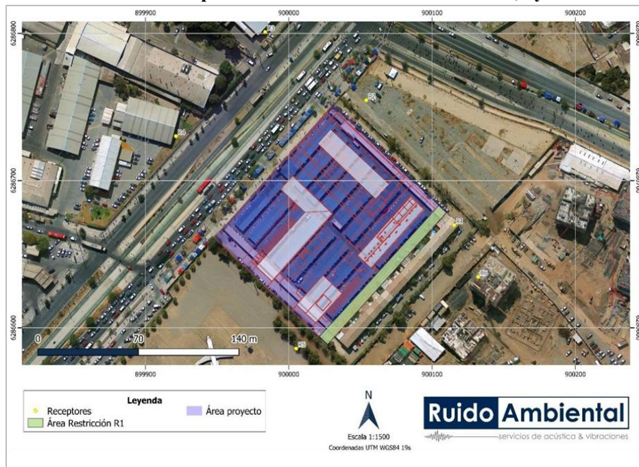
Imagen 12.75: Áreas de Restricción para el uso de Camiones Escenario 1,2 y 3 - Fase de Construcción
