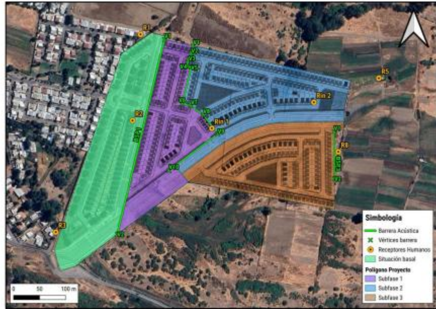
Figura. Ubicación de las barreras acústicas perimetrales a implementar en la fase de construcción.
