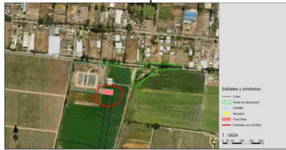
Figura 6.1.2: Mapa de ruido Situación 1, Construcción Diurno. Movimientos de tierra Con media de control de ruido. Valores proyectados en receptores.
