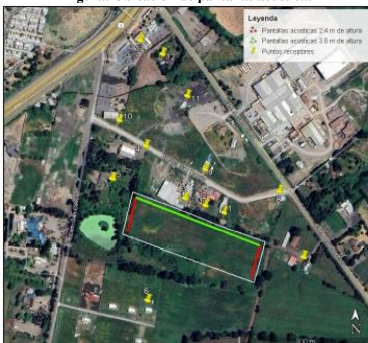
Figura: Ubicación de pantallas acústicas
