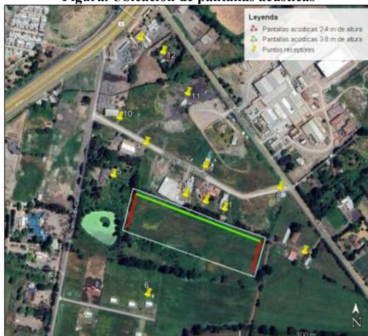
Figura. Ubicación de pantallas acústicas
