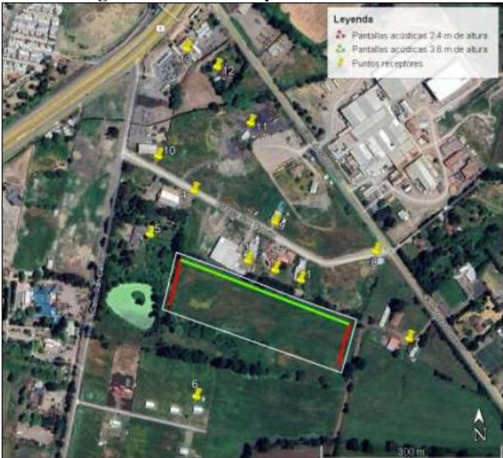
Figura. Ubicación de pantallas acústicas
