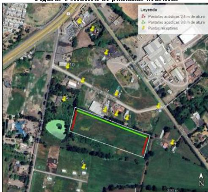
Figura. Ubicación de pantallas acústicas
