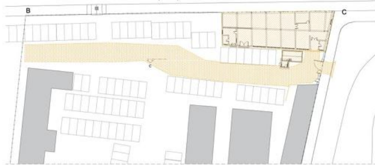
Figura 4. Edificación a demoler y pavimento de adoquines a retirar en el área de MH Hospital San José. Los adoquines serán reintegrados de acuerdo a la propuesta
