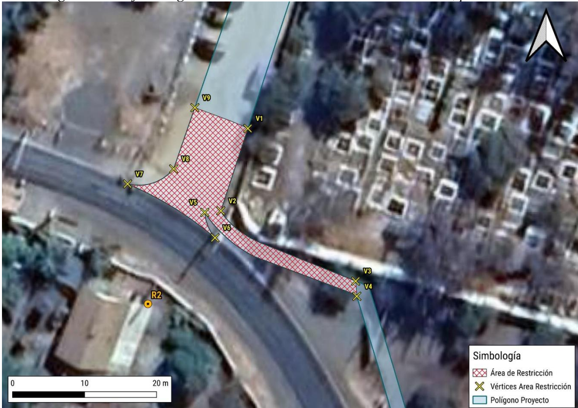
Figura 2: Franja de seguridad como medida de control de vibraciones, para rodillo.
