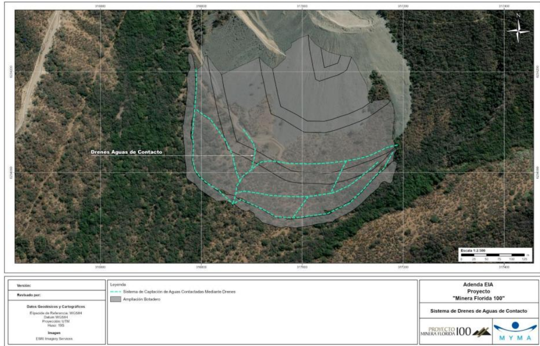
Figura 5: Sistema de drenes – Ampliación Botadero de Estériles
