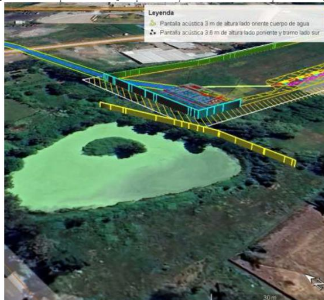
Figura. Ubicación pantallas acústicas para fauna, fases de construcción y cierre del Proyecto
