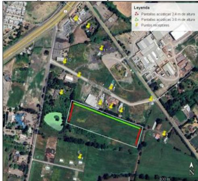
Figura. Ubicación de pantallas acústicas
