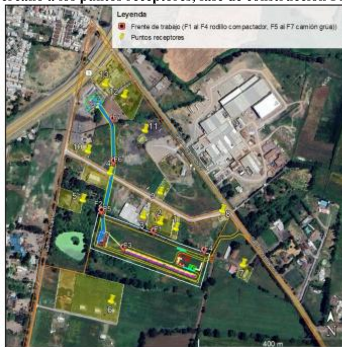
Figura. Ubicación de frente de trabajo (rodillo compactador F1 a F4, y camión grúa F5 a F7) más cercano a los puntos receptores, fase de construcción Proyecto
