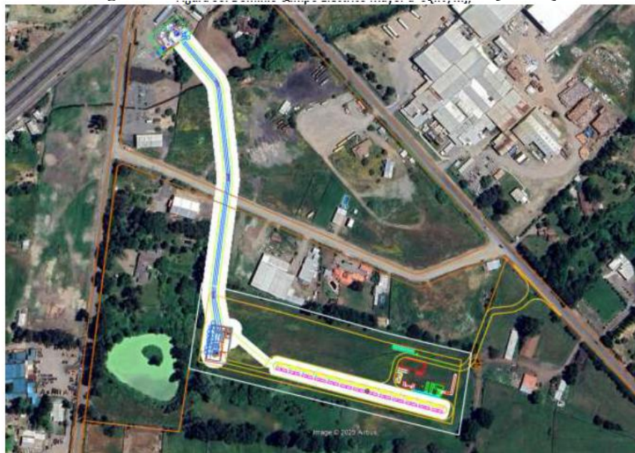
Figura. Dominio Campo Eléctrico Mayor a 5 [kV/m]
