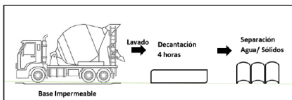
Figura. Diagrama de sistema de lavado de canoas de camión mixer
