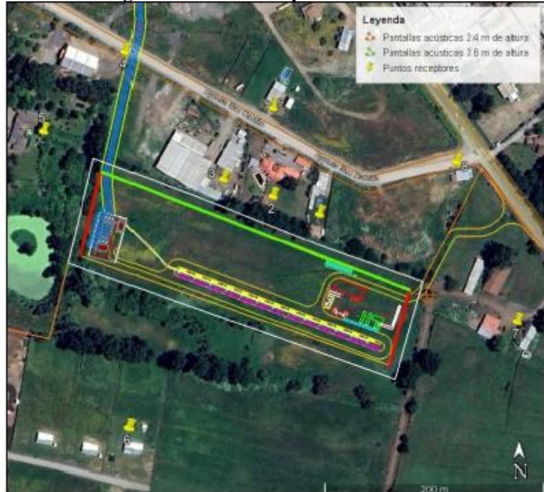
Figura: Ubicación de pantallas acústicas
