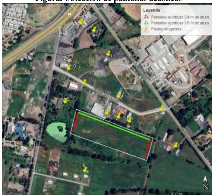
Figura. Ubicación de pantallas acústicas
