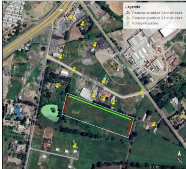
Figura. Ubicación de pantallas acústicas
