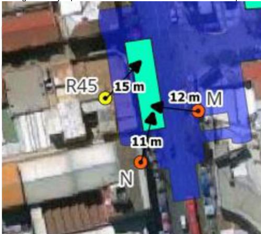
Figura 11: Ejemplo de error de cálculo de distancia brocal-receptor
