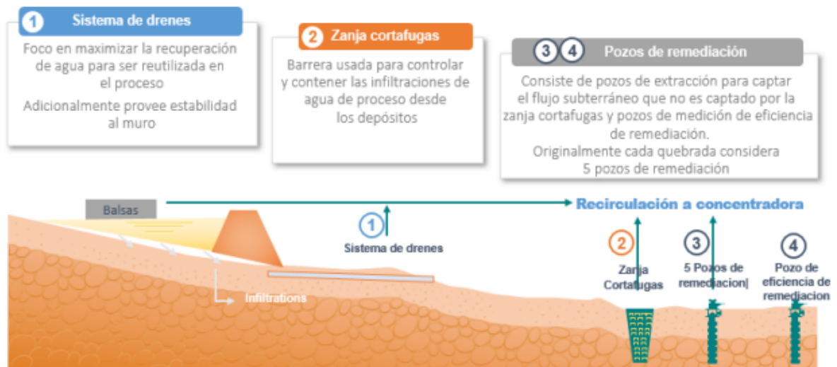
Figura 1-4: Sistema de control de infiltraciones.
