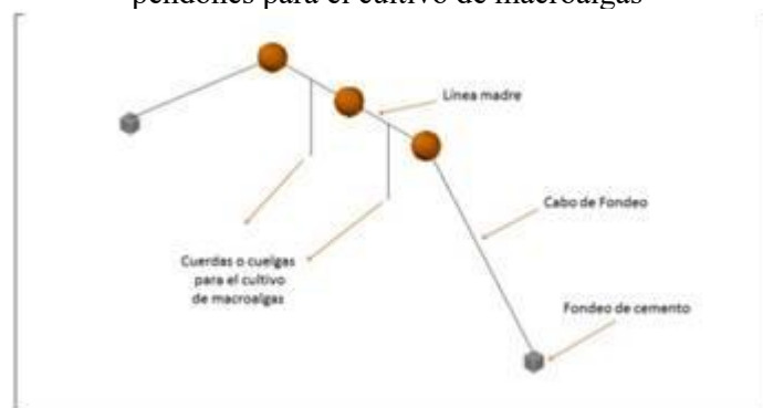
Figura 4.2.2. Esquema general del sistema de cultivo de macroalgas, línea madre, sistema de fondeo y cuerdas o pendones para el cultivo de macroalgas
