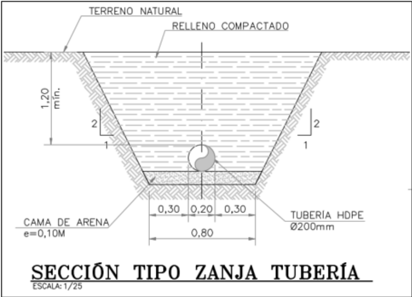
Figura 11. Sección tubería a presión
