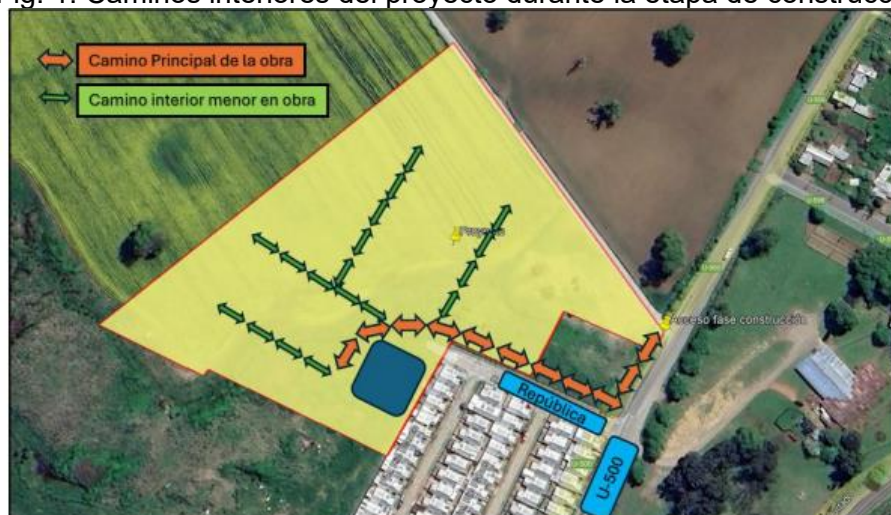
Fig. 1: Caminos interiores del proyecto durante la etapa de construcción
