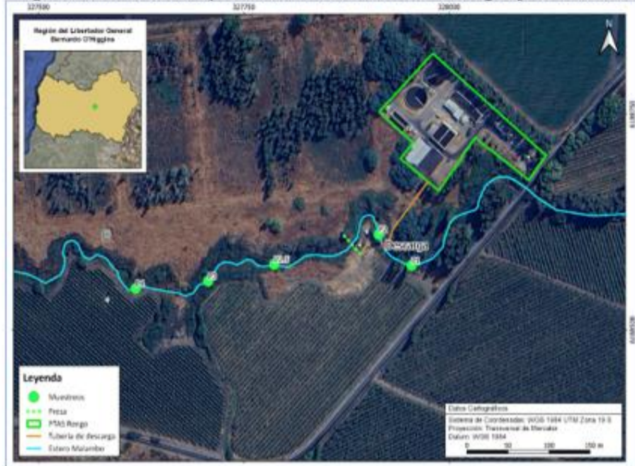
Figura. Ubicación de los puntos de muestreo de calidad de agua y sedimentos.
