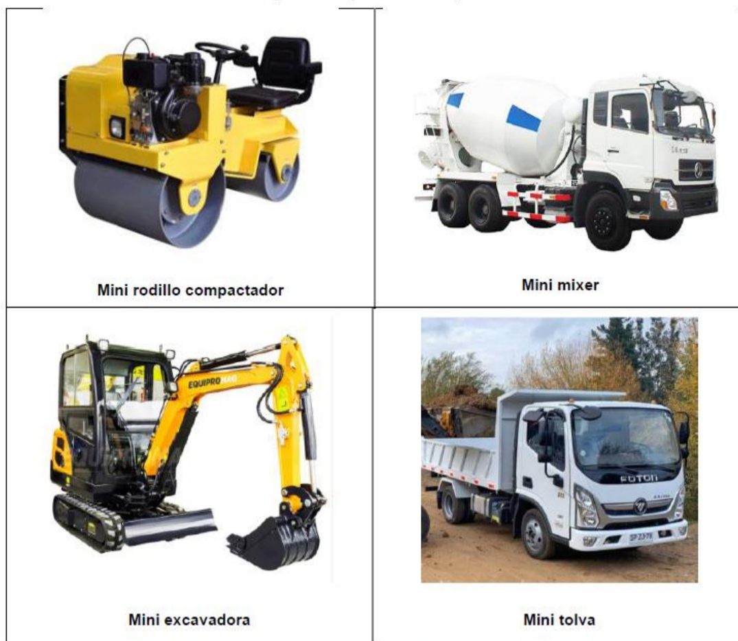
Figura 44. Maquinaria de reemplazo.
