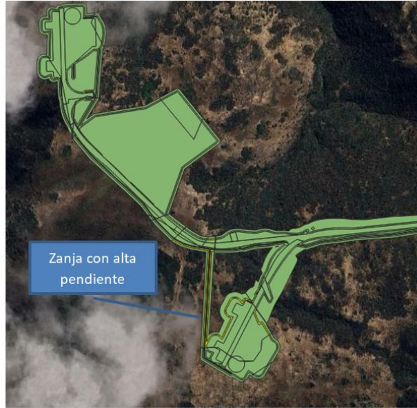
Figura 3. WTG 06 – WTG 07: Zanja con pendiente elevada
