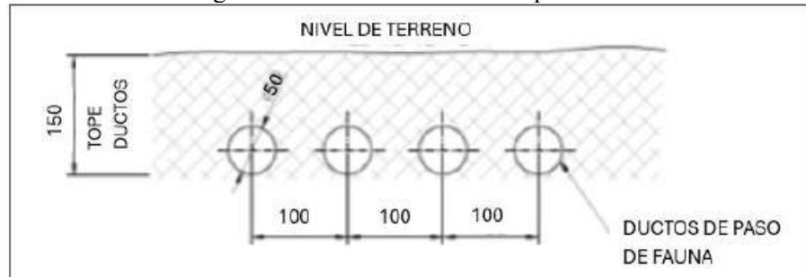
Figura 13.1.8.3: Paso de fauna tipo ducto.
