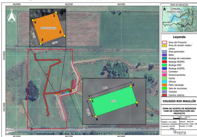
Figura N°1.5.1. Ubicación de las zonas de acopios de los residuos en la fase de construcción
