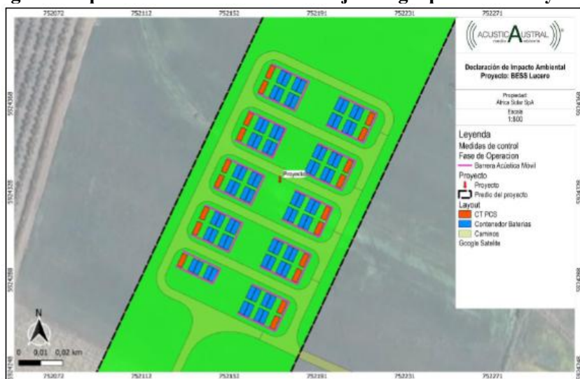
Figura. Esquema referencial barreras fijas en grupos de BESS y PCS
