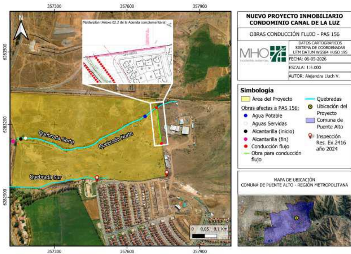
Fuente: Figura 11.3.7. Obra asociada a direccionamiento de escurrimiento superficial intermitente - Adenda Complementaria
