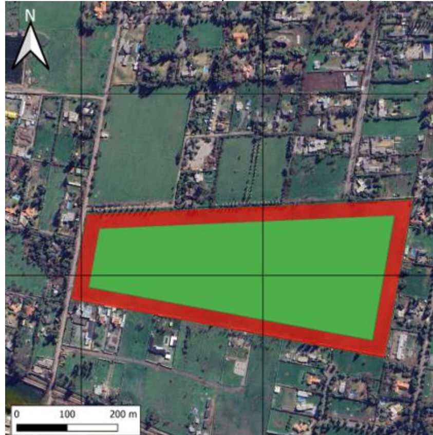
Figura 9.8.1.1: Franja de 30 metros donde solamente se pueden tener 2 maquinarias simultaneas, con un nivel de potencia total de 102 dB(A).
