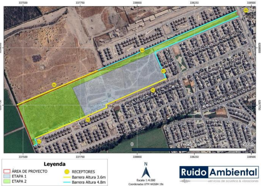
Figura 8.1.1.1. Ubicación y altura de barreras acústicas – Escenario 1.
