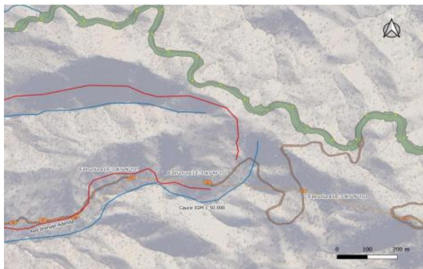
b) Interacción quebrada-camino estructura N°102. En color rojo cauce identificado en Adenda y color azul cauce fuente DGA
