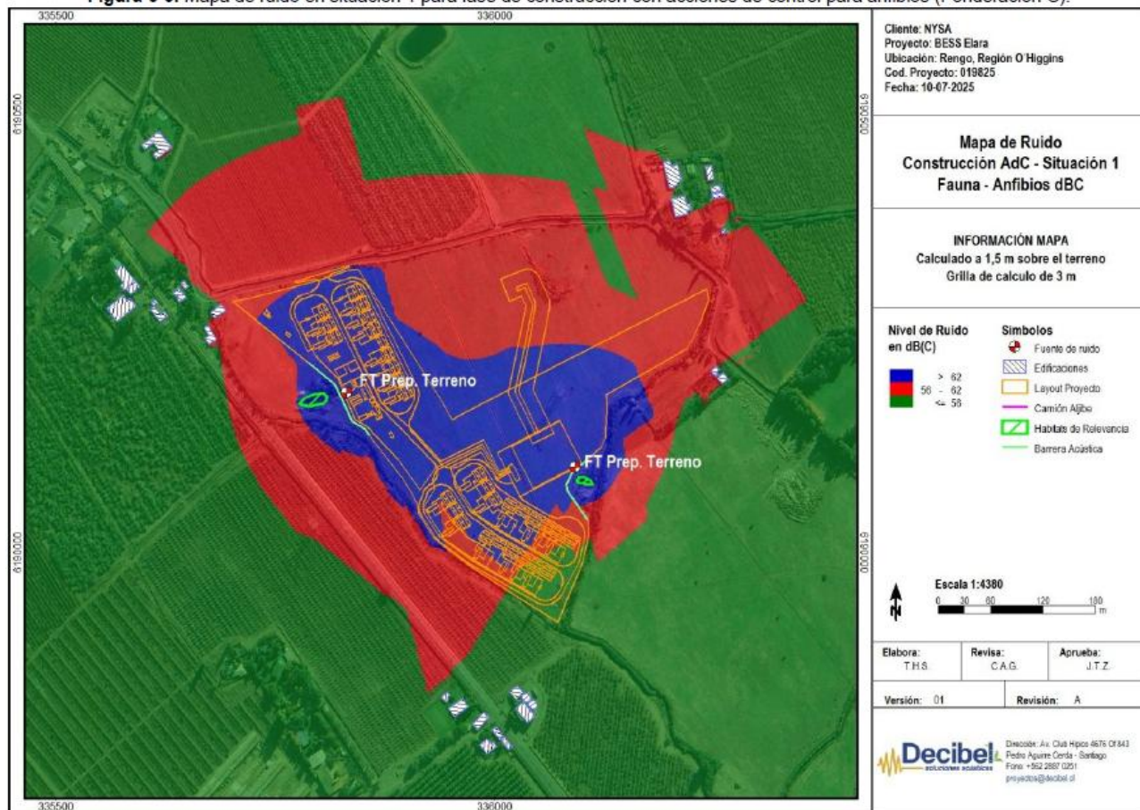
Figura 6-6: Mapa de ruido en situación 1 para fase de construcción con acciones de control para anfibios (Ponderación C).
