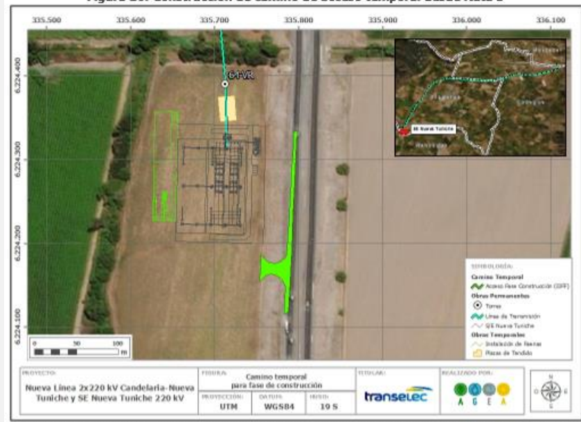
Figura 16: Construcción de camino de acceso temporal desde Ruta 5
