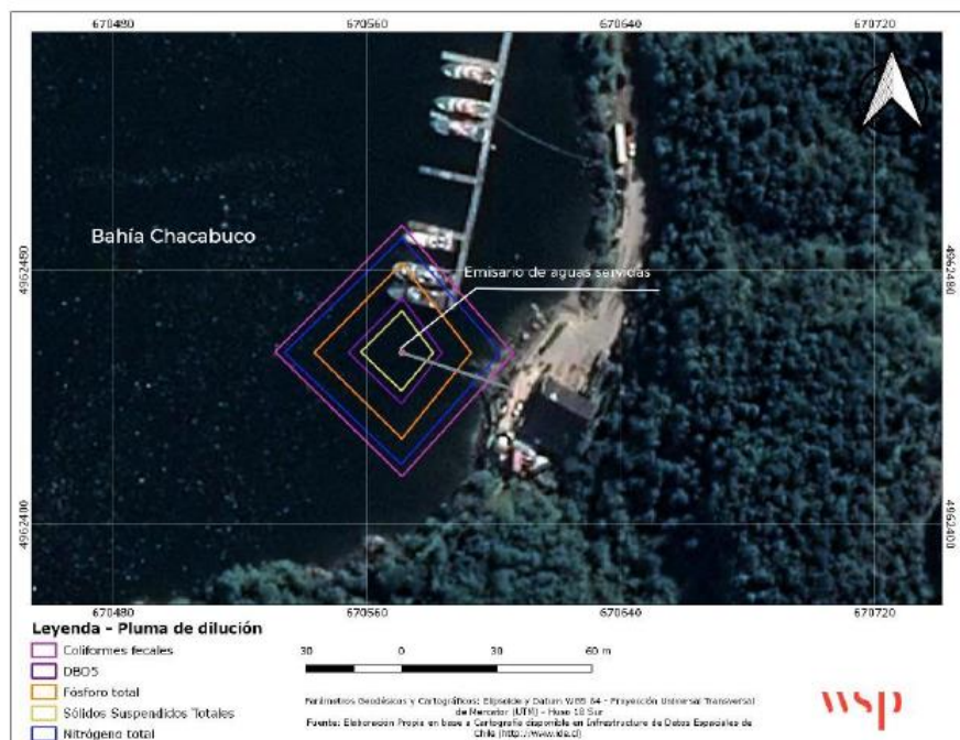
Figura 11. Figura 1 del Anexo PAC, correspondiente a la “Representación de las distancias alcanzadas para cada una de las variables simuladas bajo un escenario de corrientes máximas (Escenario 2, modelación Visual Plumes)”.
