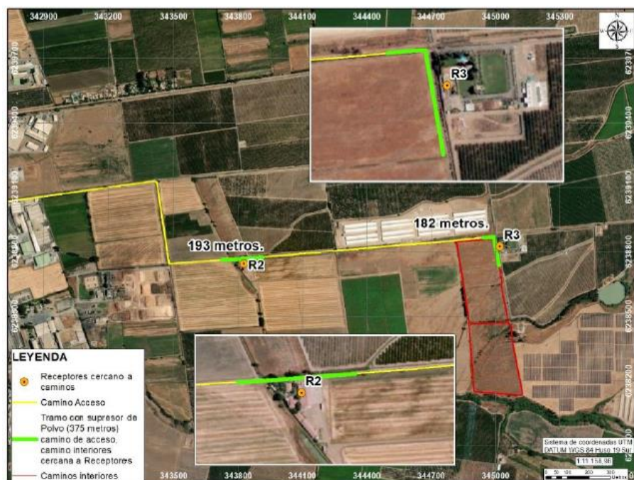
Figura 12. Tramo implementación supresor de polvo
