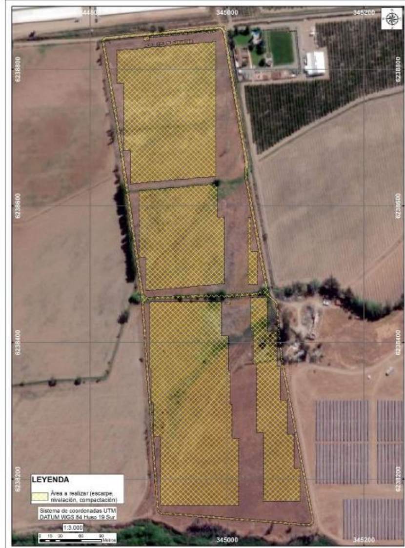
Figura 1-36. Áreas a realizar (Escarpe, nivelación, compactación)
