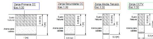
Figura 1-17. dimensiones de las zanjas de cableado
