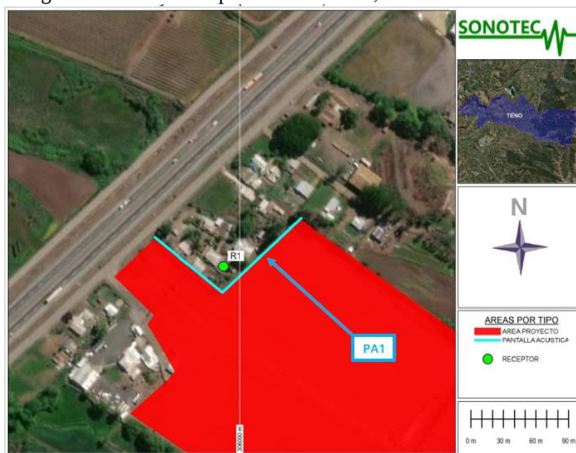
Figura N°4. Ubicación pantallas acústicas, fases de construcción.
