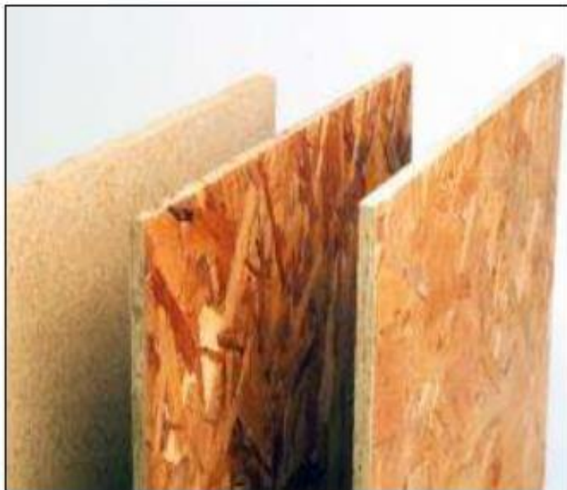
Figura 1: Materialidad barrera perimetral OSB (Fuente: Extracto informe de ruido y vibraciones adjunto en el Anexo AC-02 de la Adenda complementaria).
