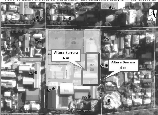
Figura. Ubicación y alturas de barreras acústicas –Excavación, obra gruesa y terminaciones LOTE 4a.
