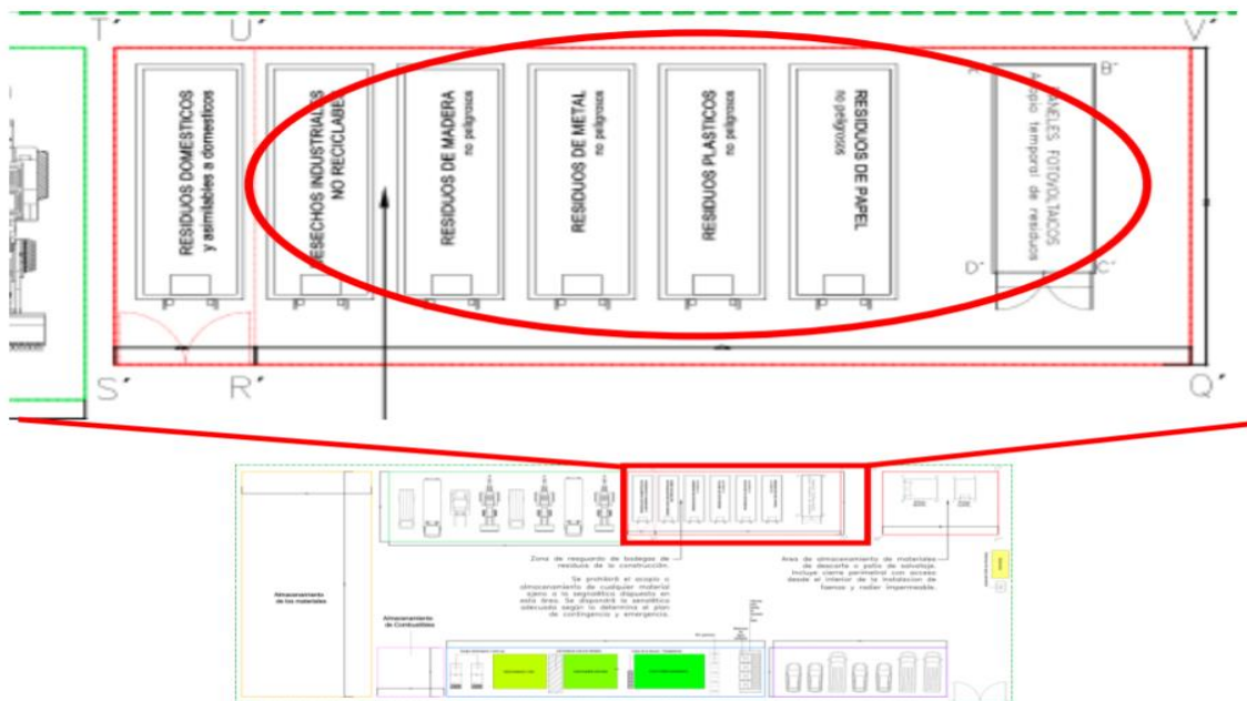
Figura N°5. Ubicación de contenedores para disposición de residuos industriales no peligrosos- Fase de construcción:
