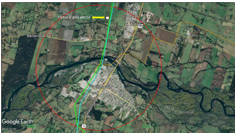
Figura 1. Círculo para emplazamiento de la Subestación (fuente Google Earth).
