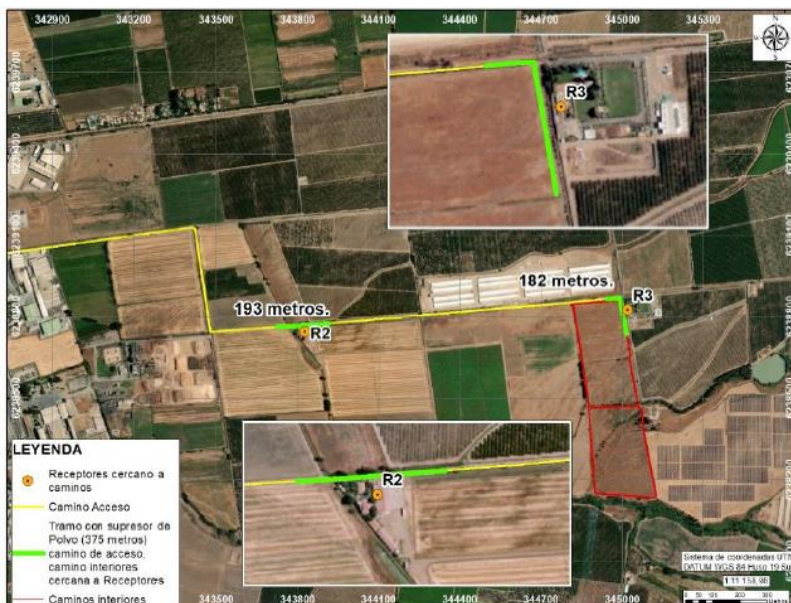
Figura 12. Tramo implementación supresor de polvo
