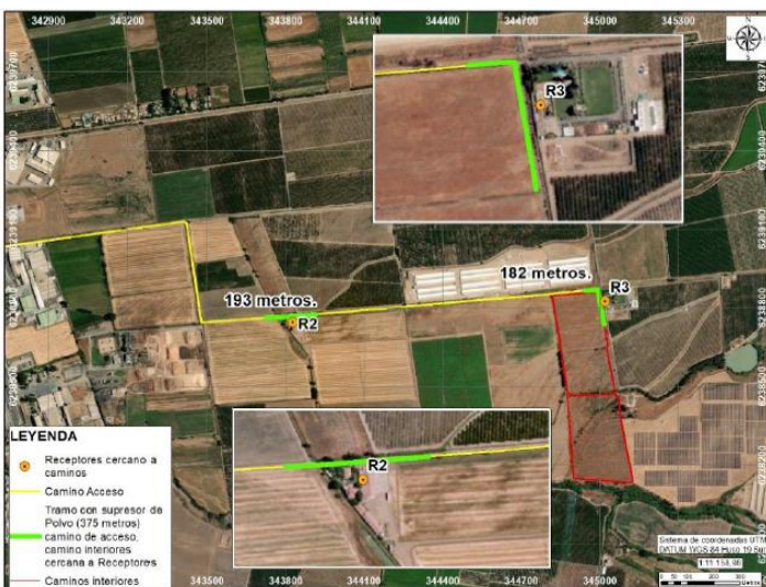
Figura 12. Tramo implementación supresor de polvo
