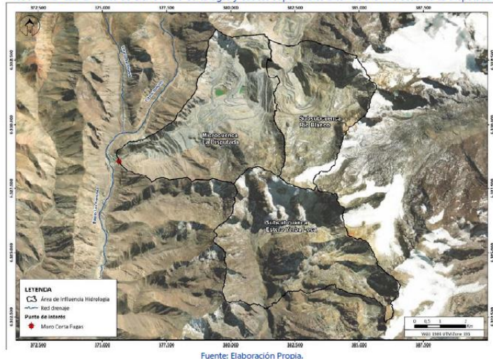
FIGURA AD-122-1: Punto de Cierre Muro Cortafugas y Cauces Superficiales Externos a la Microcuenca La Disputada
