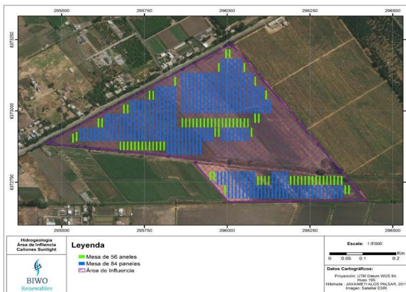
Figura 4.1.1: Distribución de paneles.
