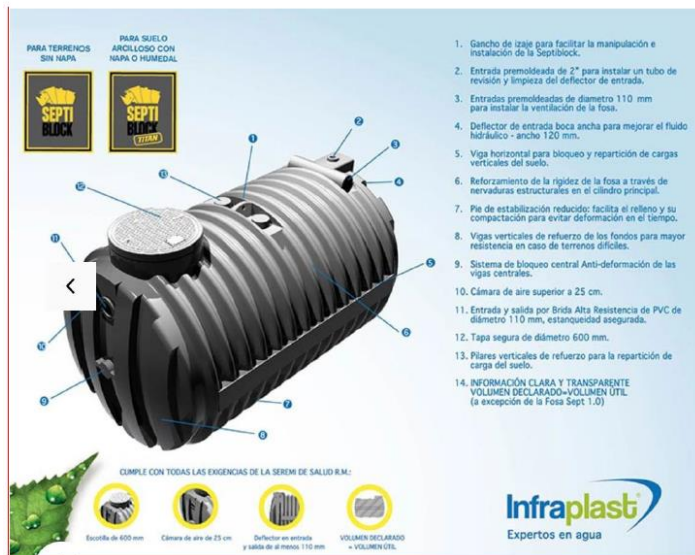
ILUSTRACIÓN 2. DETALLES TÉCNICOS FOSA SEPTICA
