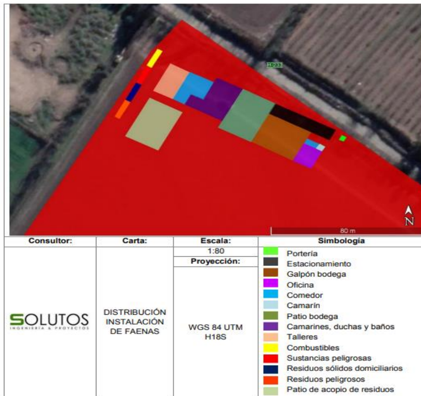
Figura 2. Distribución de la instalación de faenas.
