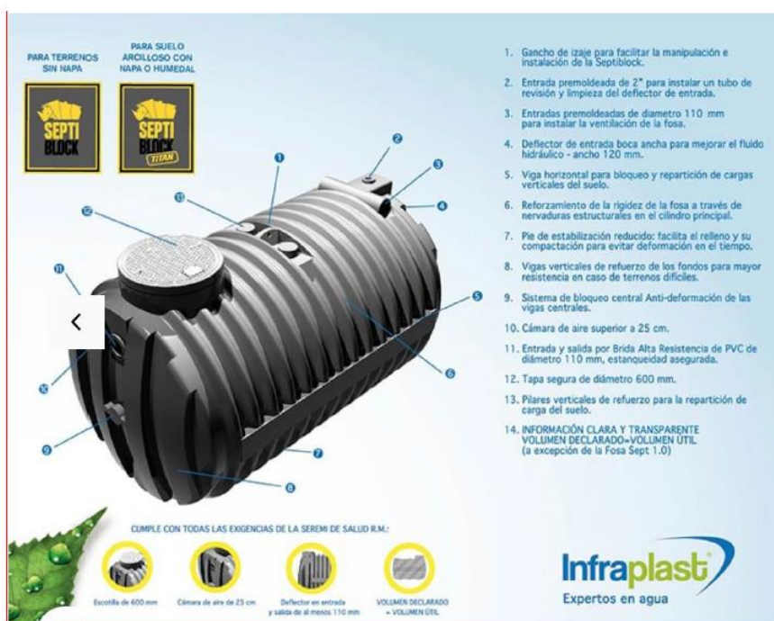
ILUSTRACIÓN 2. DETALLES TÉCNICOS FOSA SEPTICA
