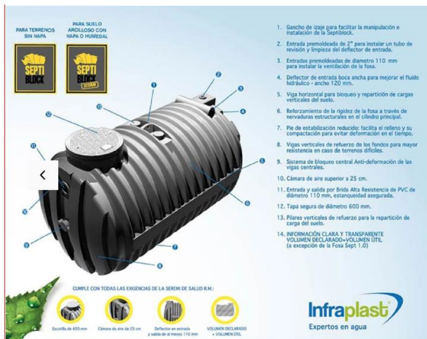
ILUSTRACIÓN 2. DETALLES TÉCNICOS FOSA SEPTICA
