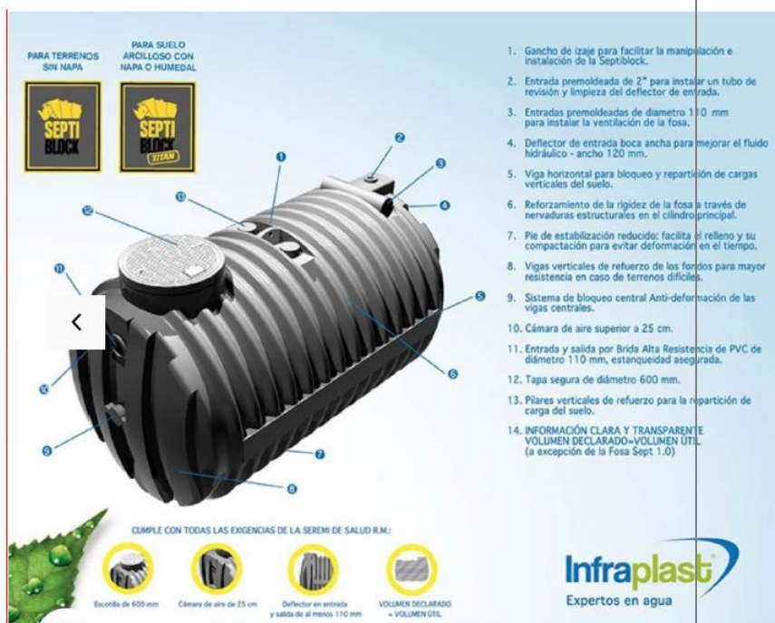
ILUSTRACIÓN 2. DETALLES TÉCNICOS FOSA SEPTICA
