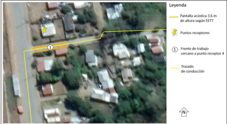
Figura 67. Ubicación de pantallas acústicas móviles etapa de construcción del Proyecto. Trabajos de trazado de impulsión frente a punto receptor 4.
