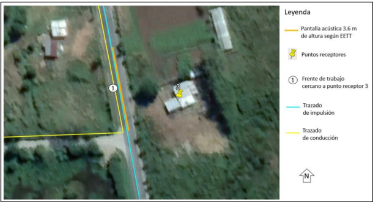
Figura 66. Ubicación de pantallas acústicas móviles etapa de construcción del Proyecto. Trabajos de trazado de impulsión y conducción frente a punto receptor 3.
