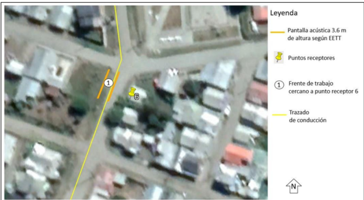
Figura 69. Ubicación de pantallas acústicas móviles etapa de construcción del Proyecto. Trabajos de trazado de impulsión frente a punto receptor 6.
