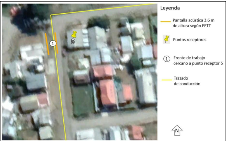
Figura 68. Ubicación de pantallas acústicas móviles etapa de construcción del Proyecto. Trabajos de trazado de impulsión frente a punto receptor 5.
