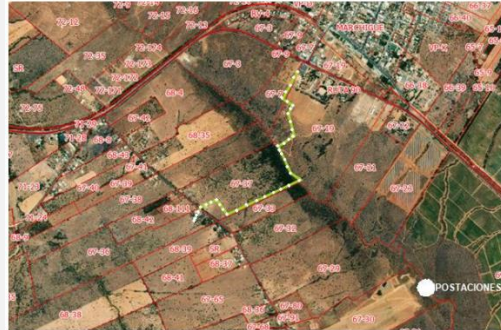
Figura 1-1. Línea de media tensión y rol predios por los cuales atraviesa Fuente: https://esri.citron.cl/portal/apps/webappviewer
