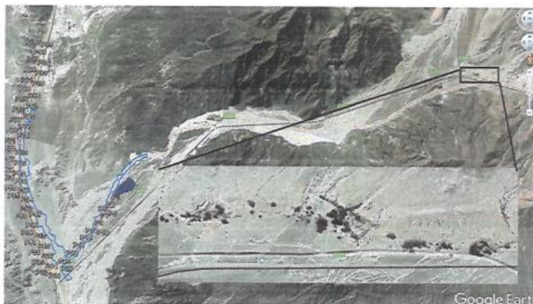
Figura 6. Evidencia de aguas subterráneas someras o surgencias de agua, detectada aguas arriba del Proyecto. Fuente: elaboración propia, construido en el Google Earth, incorporando información digital presentada por el Titular en formato KMZ, en el Anexo 1 de la Adenda en evaluación.
