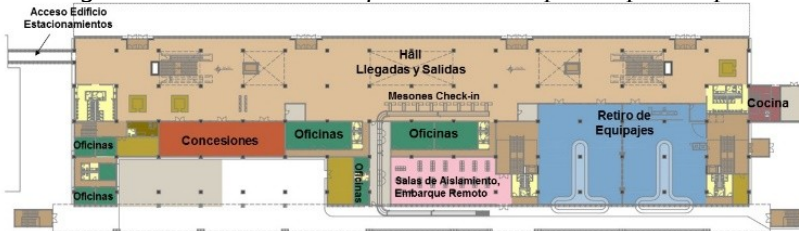
Figura N°5: Nuevo Edificio Terminal, planta primer piso
