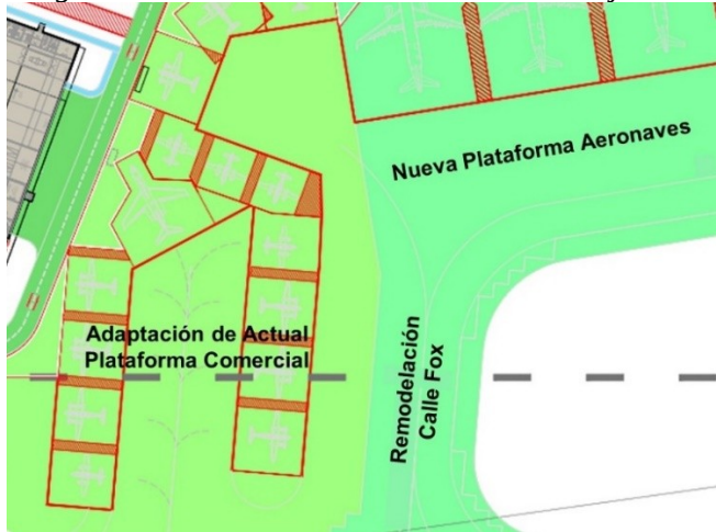
Figura N° 3: Remodelación Calle de Rodaje Fox
