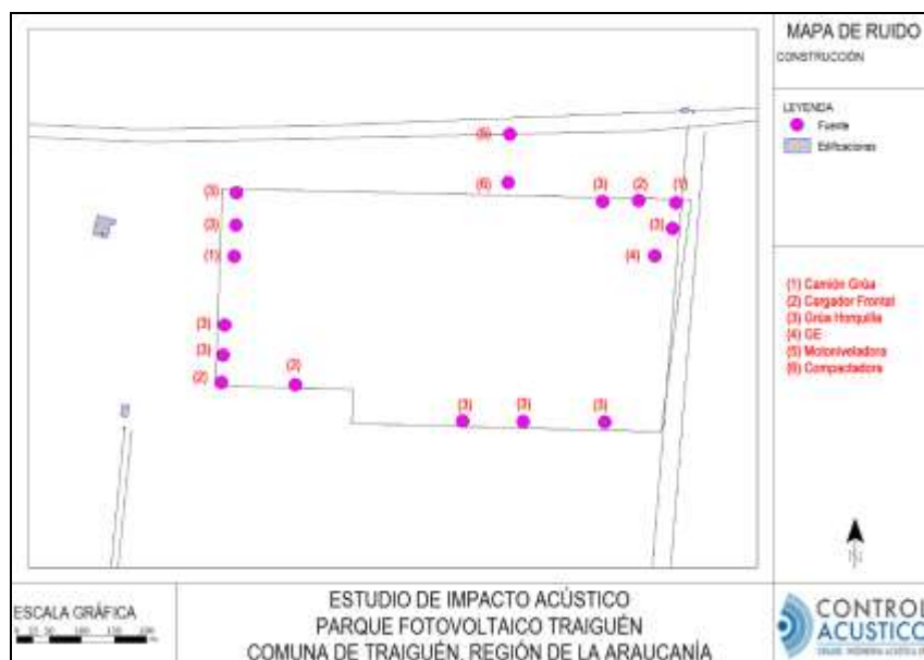
Imagen 13. Esquema modelo acústico para fase de construcción.
