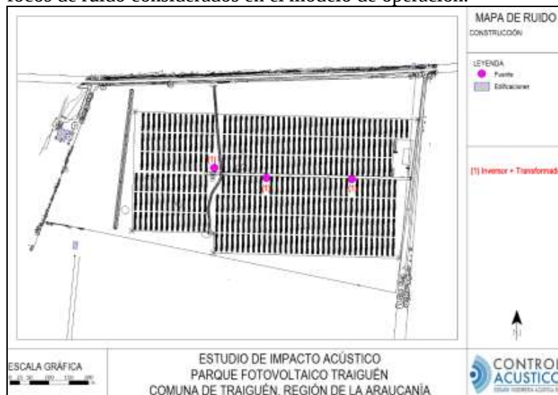
Imagen 25. Distribución focos de ruido en fase de operación
