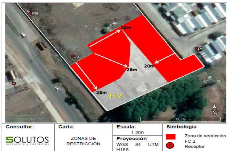
Figura. Zona de restricción uso de rodillo compactador FC 2.
