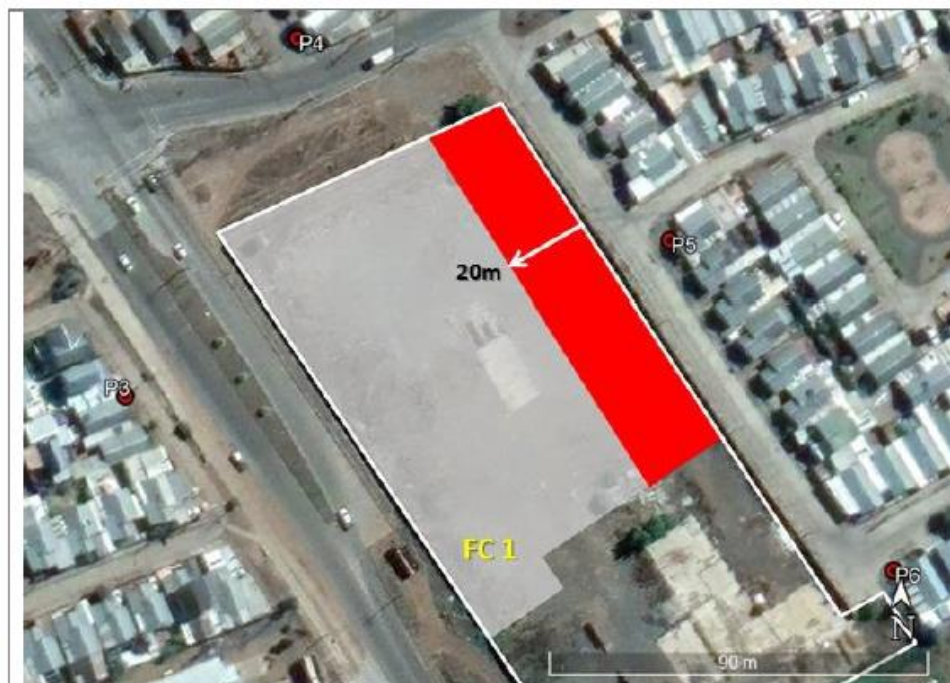
Figura. Zona de restricción uso de rodillo compactador FC 1.
