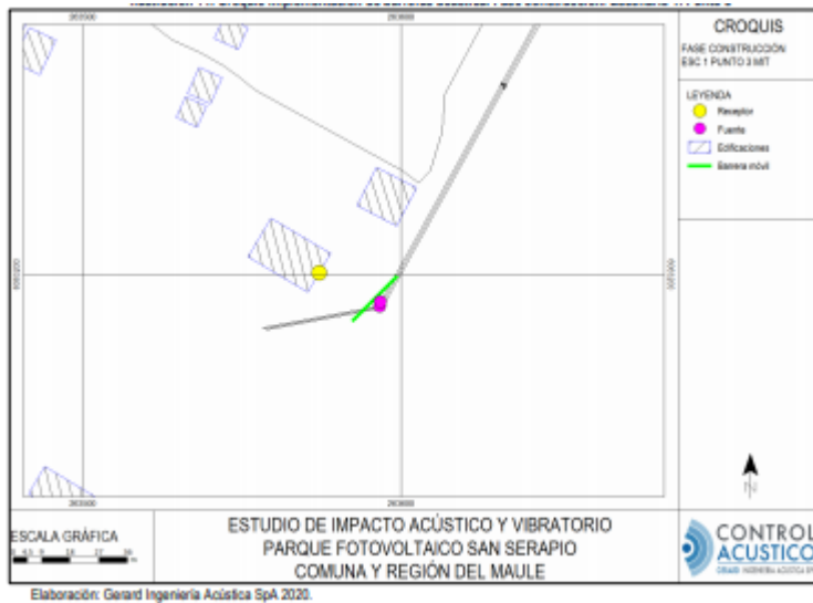
Figura N°4. Croquis implementación de barreras acústica. Fase construcción. Escenario 1. Punto 3.
